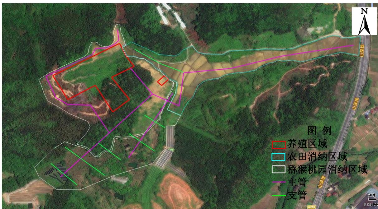
图 5.2-14 废水农灌输送系统设计图
